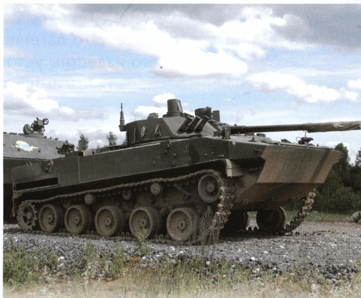
На этом фото БМД-4М хорошо видна возможность работы подвески по изменению клиренса машины.
