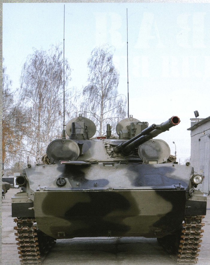
Боевая машина десанта БМД-4, вид спереди. В лобовом листе слева видна амбразура для пулемета РПКС-74.
